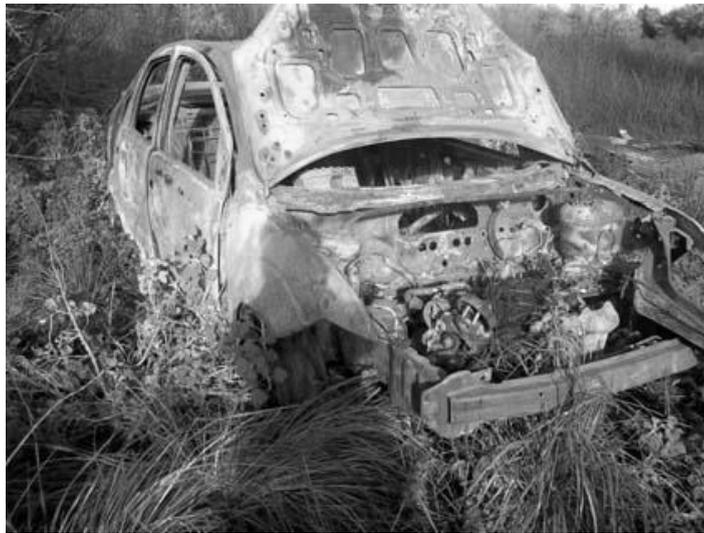
Los restos de la unidad presentan una elevadísima intensidad destructiva observándose en la mayor parte de la estructura metálica del chasis –chapa de hierro- rastros de calcinación, lo que demuestra que el metal llegó al estado de
